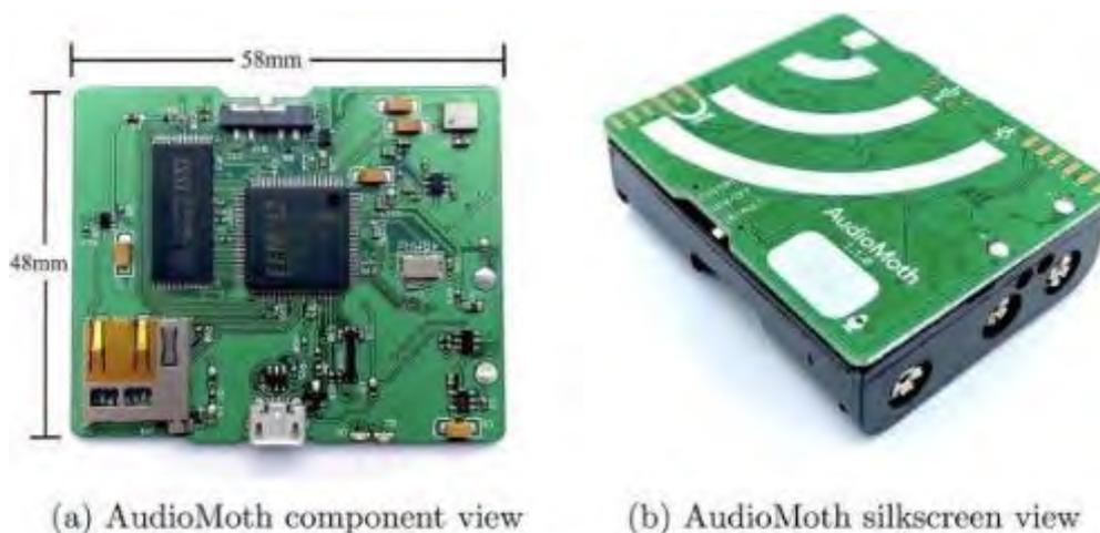
Figura 33. Audiomoth: vista del interior (a) y del exterior (b). Fuente: Hill et al. (2019).
