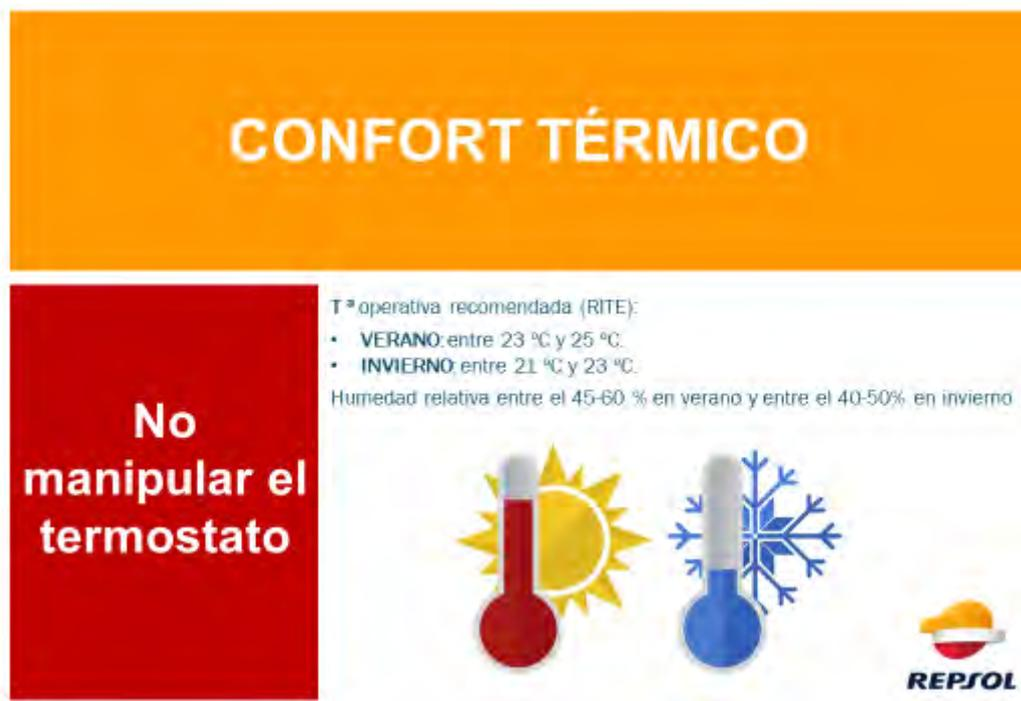
Figura 72. Señalización temperatura termostato en las SET.
