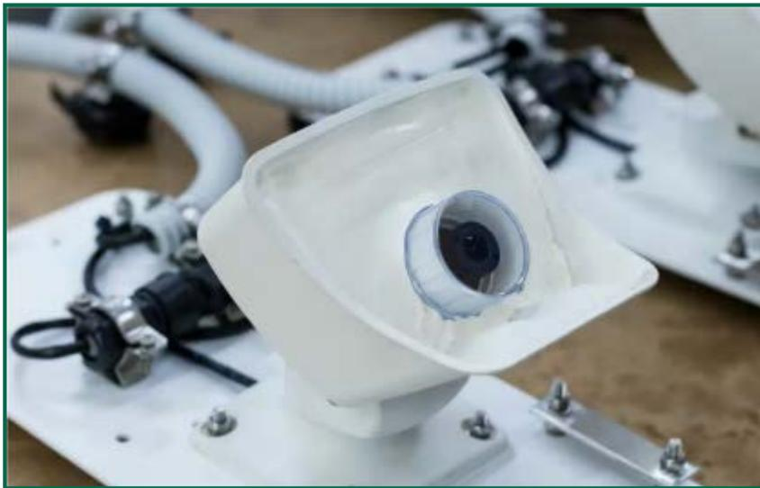
Fotografía 17. Nuevas carcasas para las cámaras de detección de DtBird.
