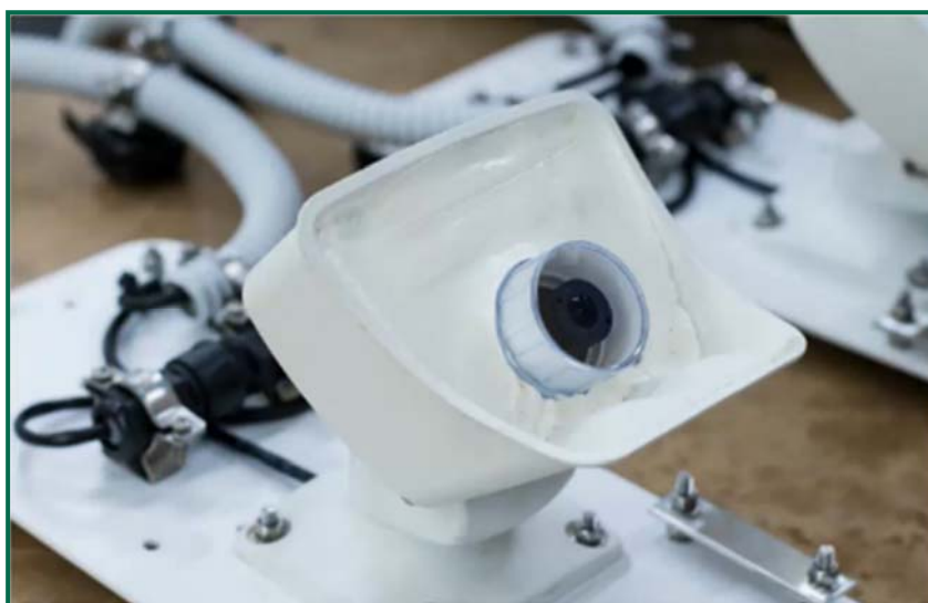
Fotografía 19. Nuevas carcasas para las cámaras de detección de DtBird.
