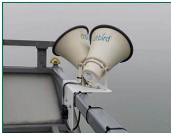
Fotografía 21. Sistema de anclaje de los altavoces.
