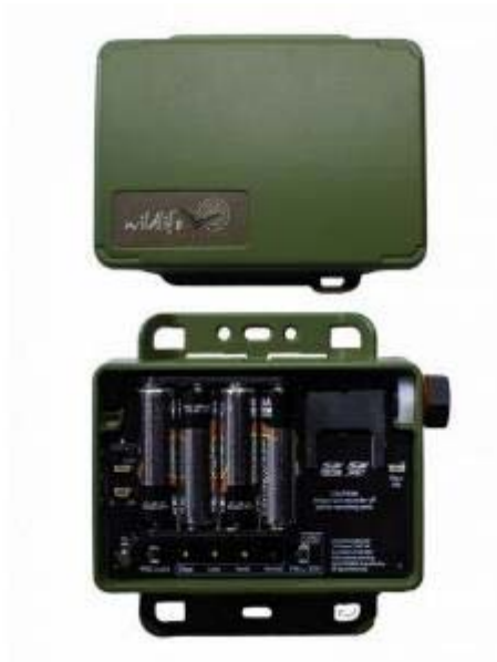
Figura 28. Mini Bat: vista del interior (a) y del exterior (b). Fuente: WildLife Acoustics.
