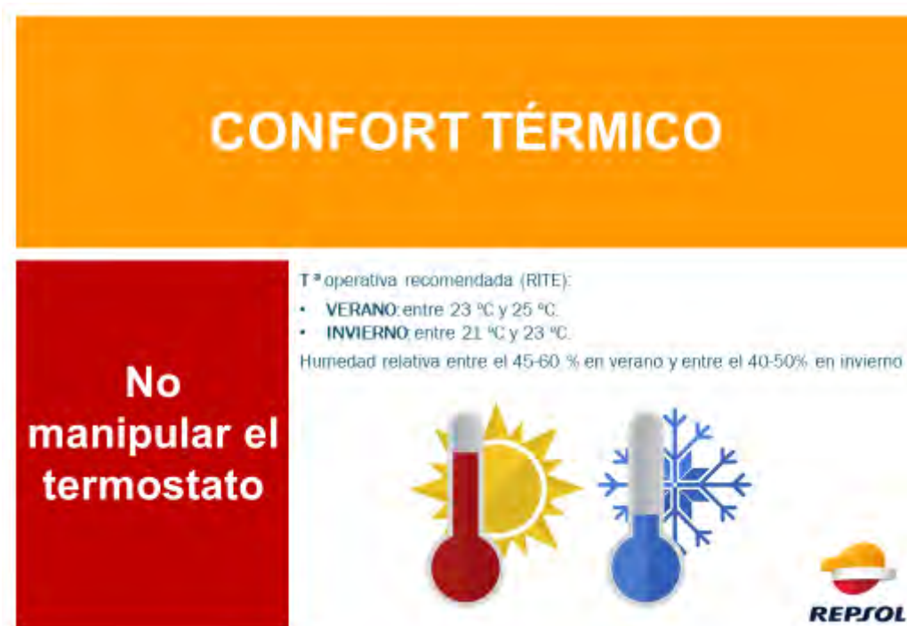
Figura 43. Señalización temperatura termostato en las SET.
