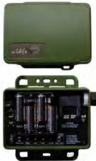
Figura 36. Mini Bat: vista del interior (a) y del exterior (b). Fuente: WildLife Acoustics.
