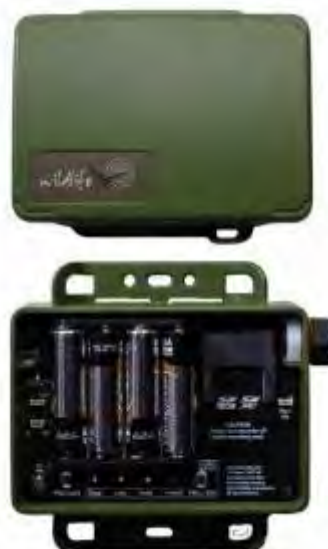
Figura 37. Mini Bat: vista del interior (a) y del exterior (b). Fuente: WildLife Acoustics.
