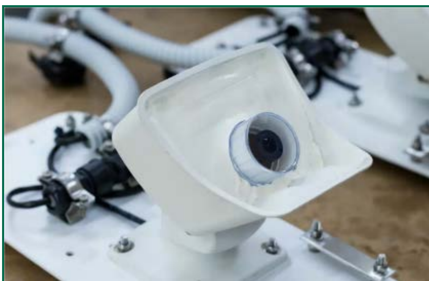
Fotografía 18. Nuevas carcasas para las cámaras de detección de DtBird.
