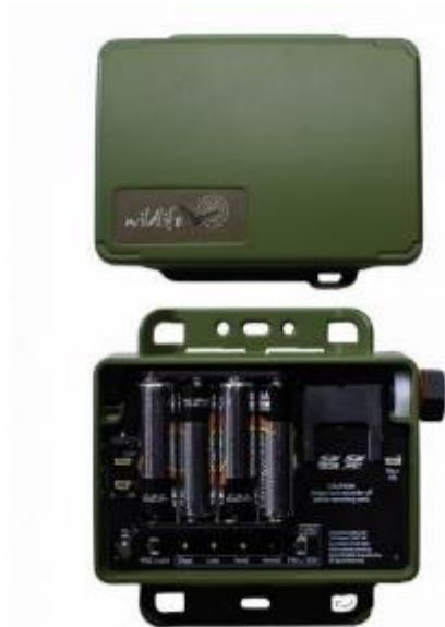
Figura 28. Mini Bat: vista del interior (a) y del exterior (b). Fuente: WildLife Acoustics.
