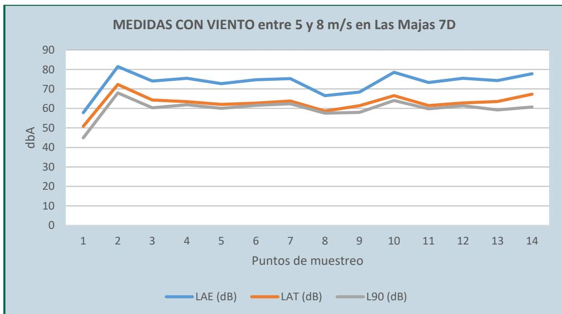
Figura 63. Registros en los puntos de medida., entre 5 y 8 m/s
