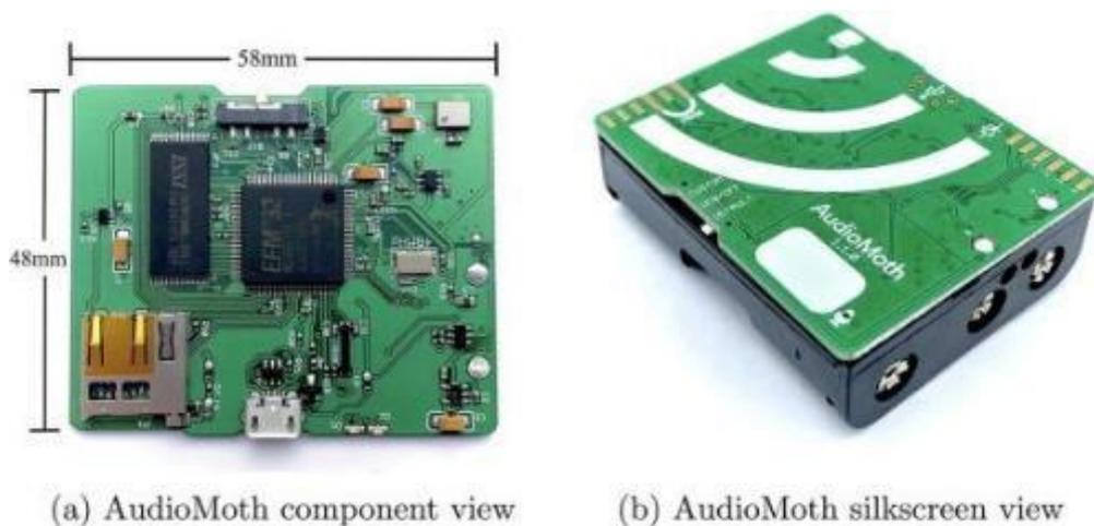
Figura 26. Audiomoth: vista del interior (a) y del exterior (b). Fuente: Hill et al. (2019).
