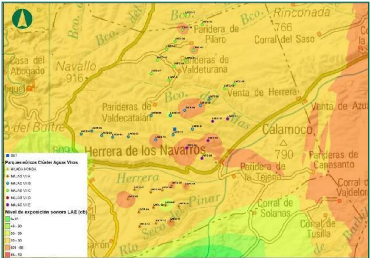
Figura 64. Distribución espacial hallada mediante dos tipos de interpolación diferentes (IDW) de los datos medidos en campo con una velocidad de viento entre 5 y 8 m/s y parques eólicos en funcionamiento.
