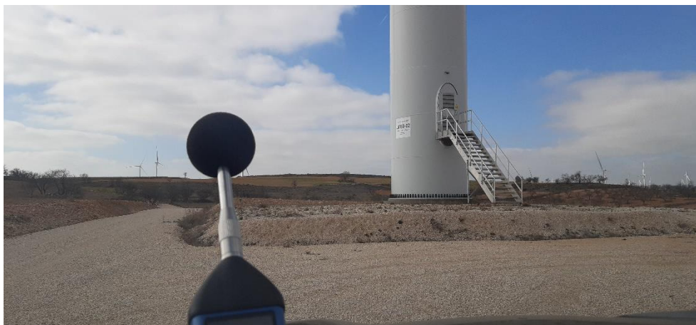
Foto 1. Medición sonómetro en L6D – 02. Aerogenerador funcionando. Viento suave
