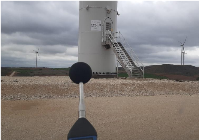
Fig. 1 Medición acústica en L6C.11. Fuente: Elaboración propia
