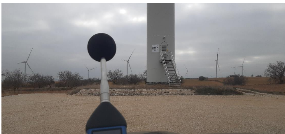
Foto 1. Medición sonómetro en L6B – 06. Aerogenerador parado. Viento suave.
