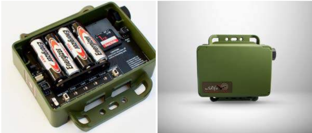
Figura 12. Song Meter Mini Bat Ultrasonic Recorder. Fuente: Wildlife Acoustics.
