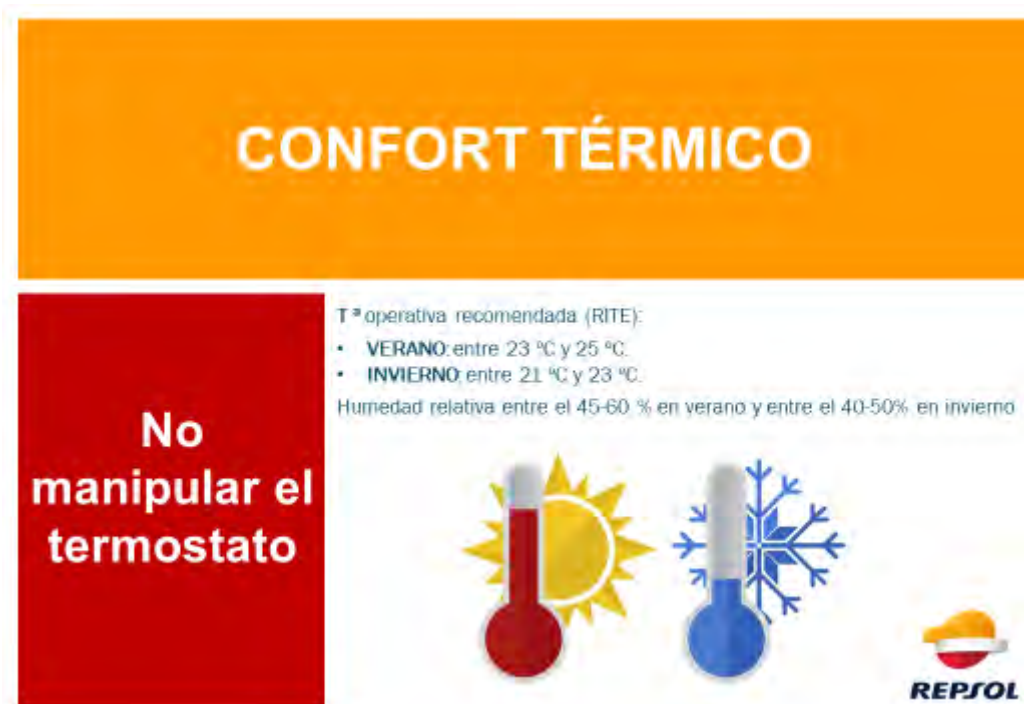
Figura 23. Señalización temperatura termostato en las SET.
