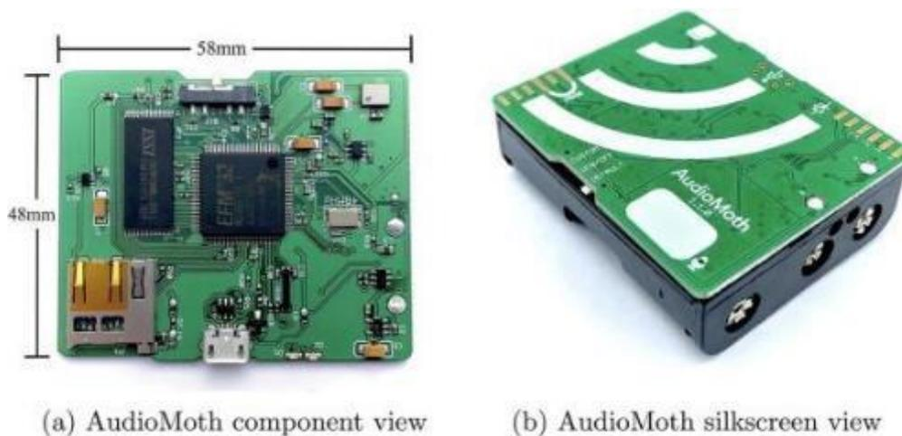
Figura 14. Audiomoth: vista del interior (a) y del exterior (b). Fuente: Hill et al. (2019).
