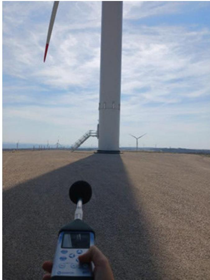
*Figura 1: Ejemplo de medición ruido en COT-01*
