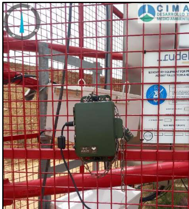
Fotografía 1. Sensor colocado en la antena meteorológica para el seguimiento de murciélagos.
