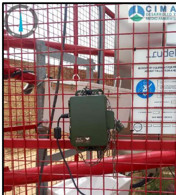
Fotografía 1. Sensor colocado en la antena meteorológica para el seguimiento de la diversidad de murciélagos.
