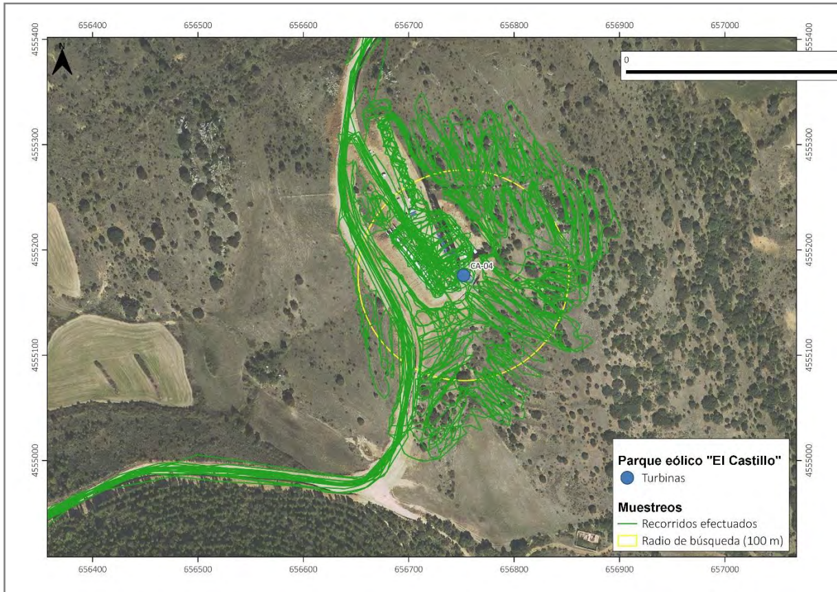
Ilustración 2. Ejemplos de recorridos efectuados para la búsqueda de siniestros en la turbina CAS04 del parque eólico "El Castillo".
