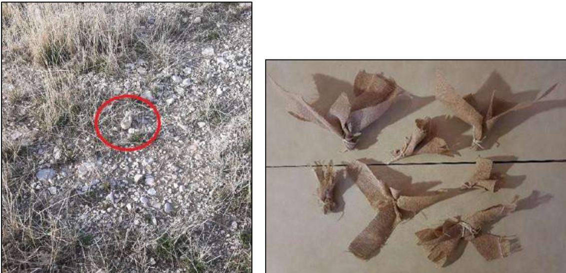
Figura 5: Ejemplos de los ovillos de arpillera utilizados como señuelos durante la realización del test de detectabilidad en el parque eólico “Ampliación Puerto Escandón”.
