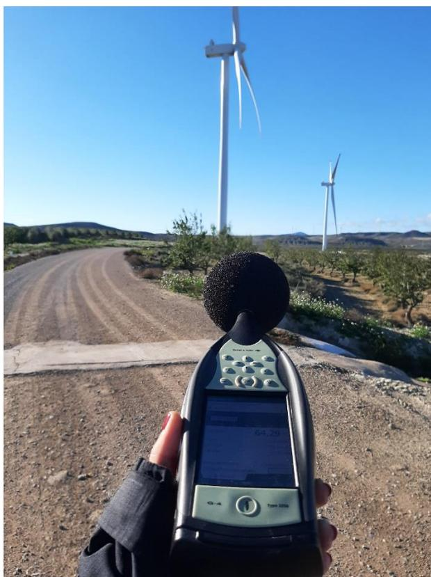
Figura 8: Sonómetro integrador modelo 2250 (G4) de Brüel & Kjaer utilizado para la evaluación de los niveles de presión sonora en el parque eólico “Agón”.
