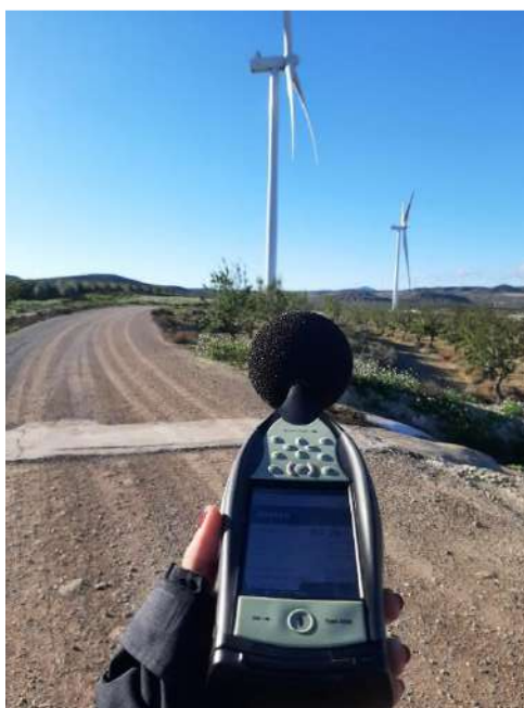
Figura 34: Sonómetro integrador modelo 2250 (G4) de Brüel & Kjaer utilizado para la evaluación de los niveles de presión sonora en el parque eólico “Agón 2”.
