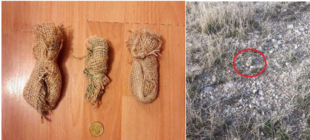
Figura 6: Ejemplo de señuelos empleados en el test de detectabilidad, y fotografía de uno de los señuelos ubicado en campo durante el test.
