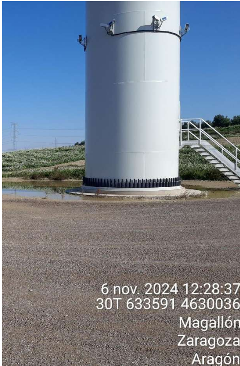
Figura 7: Sistema 3D Observer instalado en el aerogenerador AGB-02.
