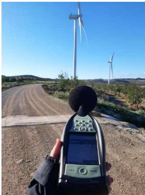
Figura 9: Sonómetro integrador modelo 2250 (G4) de Brüel & Kjaer utilizado para la evaluación de los niveles de presión sonora en el parque eólico “Agón 2”.
