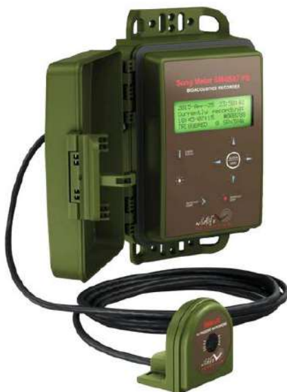
Figura 5: Detalle del dispositivo Song meter SM4 con su cubierta protectora abierta para mostrar la consola de programación y con un micrófono acoplado por cable. Más información del modelo puede consultarse en: https://www.wildlifeacoustics.com
