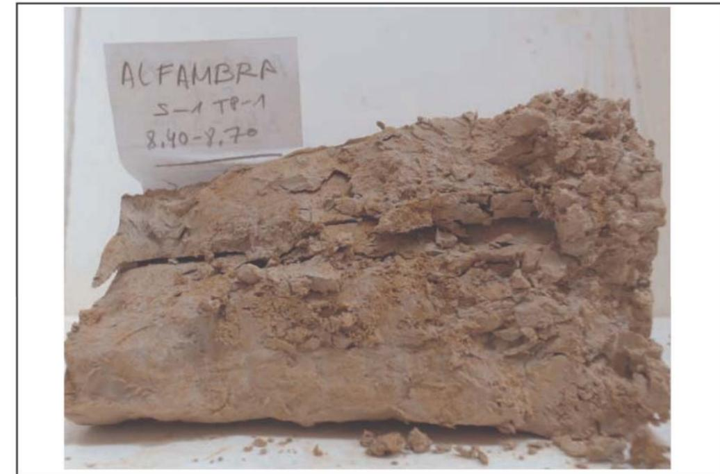
Detalle del plano de rotura
