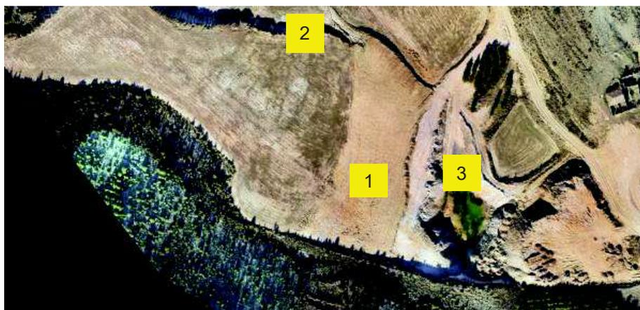
**Figura 7.-** Fotografía aérea. Fuente: elaboración propia. Puede apreciarse la zona rehabilitada, con extensión de tierra vegetal (1), enlazando con los terrenos de cultivo de cereal en secano (2), y el hueco final pendiente de rellenar actualmente destinado a balsa para agua (3) de servicio a la explotación.
