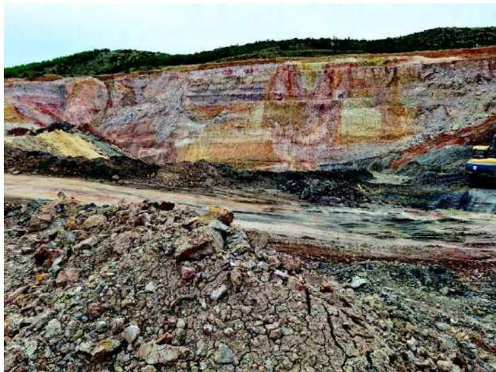
**Figura 13.-** Talud lateral del hueco de explotación actual donde se aprecia la formación Albense y su gran variabilidad
