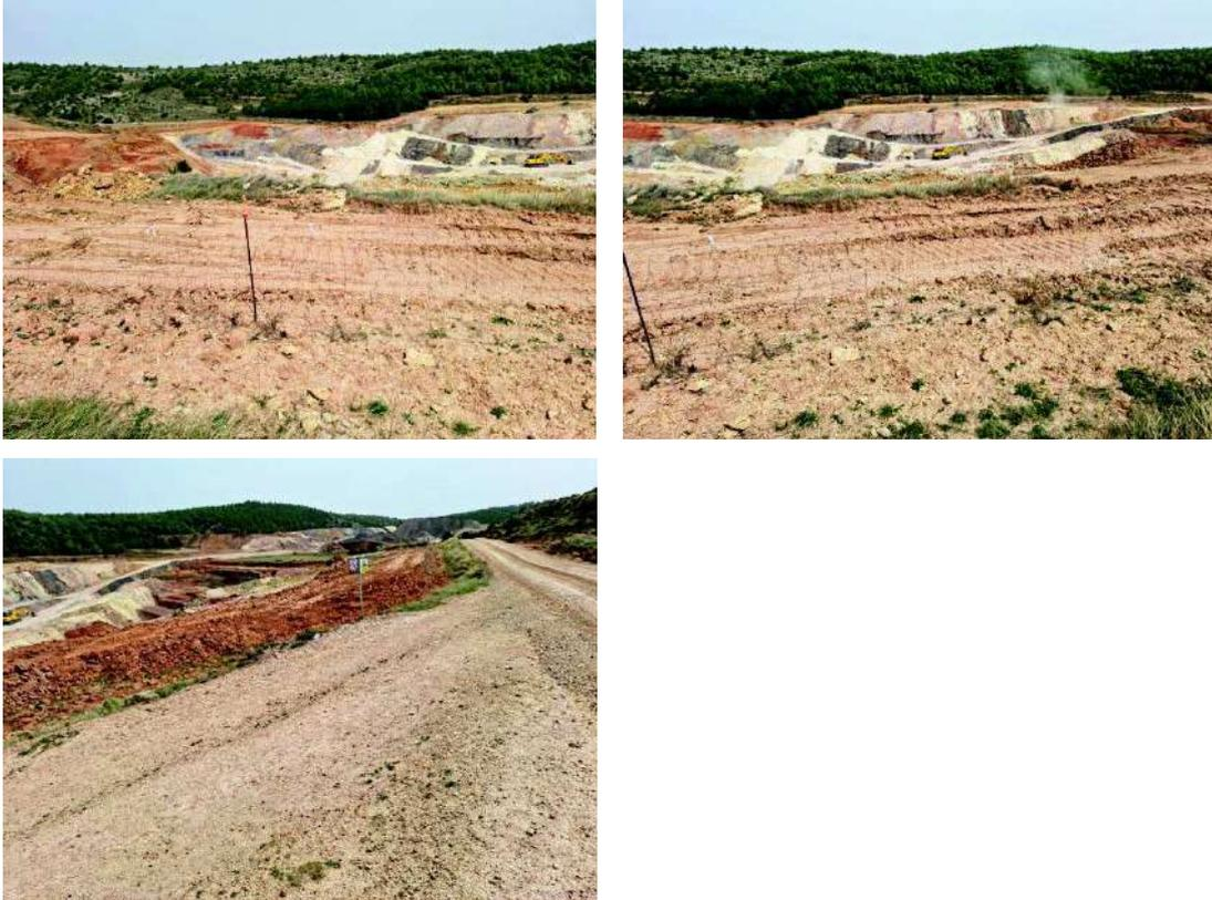
**Figura 2.** Fotografías 1 a 3. Vista general de la explotación actual, en el sector D del yacimiento. De izquierda a derecha: hueco de explotación; relleno del hueco de explotación (en la parte superior, la zona ya finalizada con reposición de tierra vegetal); abajo, al fondo la zona rehabilitada destinada a acopios
