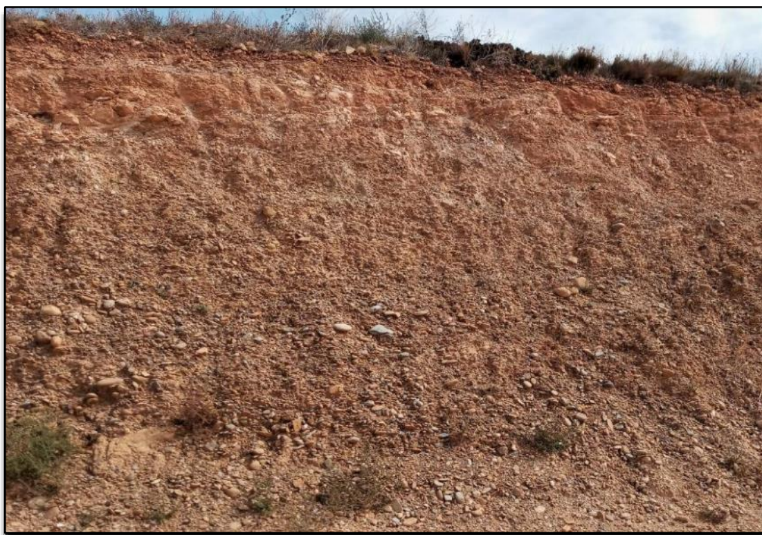
Figura nº 5. Frente de la cantera Atalaya-2 en el que se aprecia el material granular del glacis pleistoceno. Se aprecia a techo un nivel de mallacán de gran extensión lateral en la zona.
