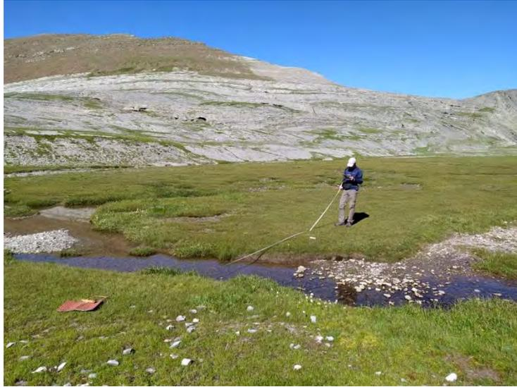
**Imagen 1.7** Cinta métrica colocada gracias a las marcas fijas en el terreno.
