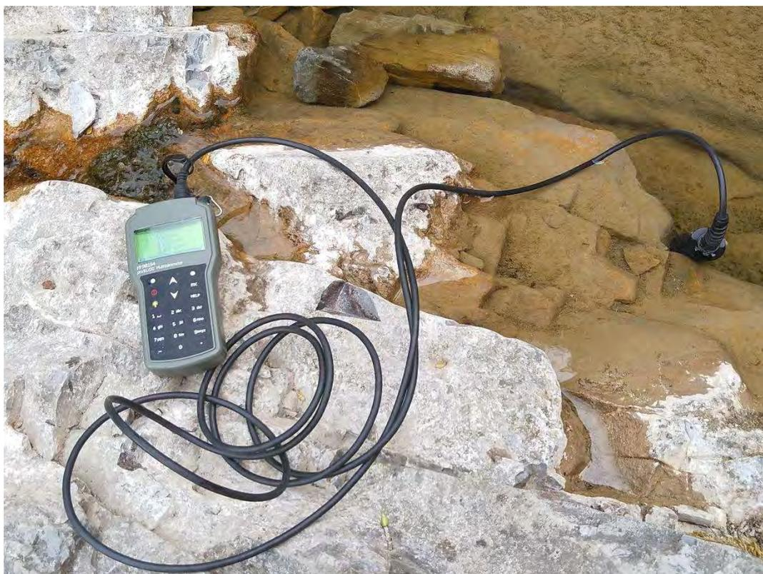
**Imagen 4.4** Toma de datos físico químico en el recipiente hídrico (Autor: Equipo de Seguimiento Ecológico del PNOMP).
