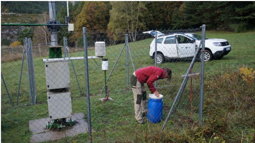
**Imagen 3.3** Toma muestras (bidón azul) en la estación meteorológica (LTER) del Parador de Ordesa.
