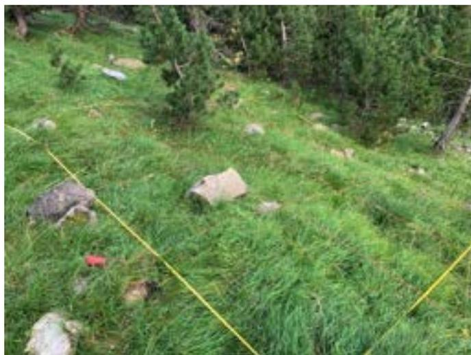
**Fotografía 1. 28** Detalle de la delimitación externa y reticulado interno de la parcela para facilitar la colocación del marco de aluminio con el que se realiza el muestreo.
