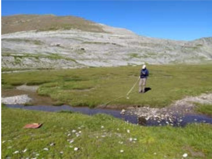
**Fotografía 1. 14** Cinta métrica colocada gracias a las marcas fijas en el terreno
