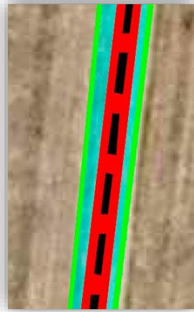
*Fig. 5. Imagen de planta de superficies afectadas por Servidumbre de Paso Subterráneo de Energía Eléctrica, marcada en color rojo.*
