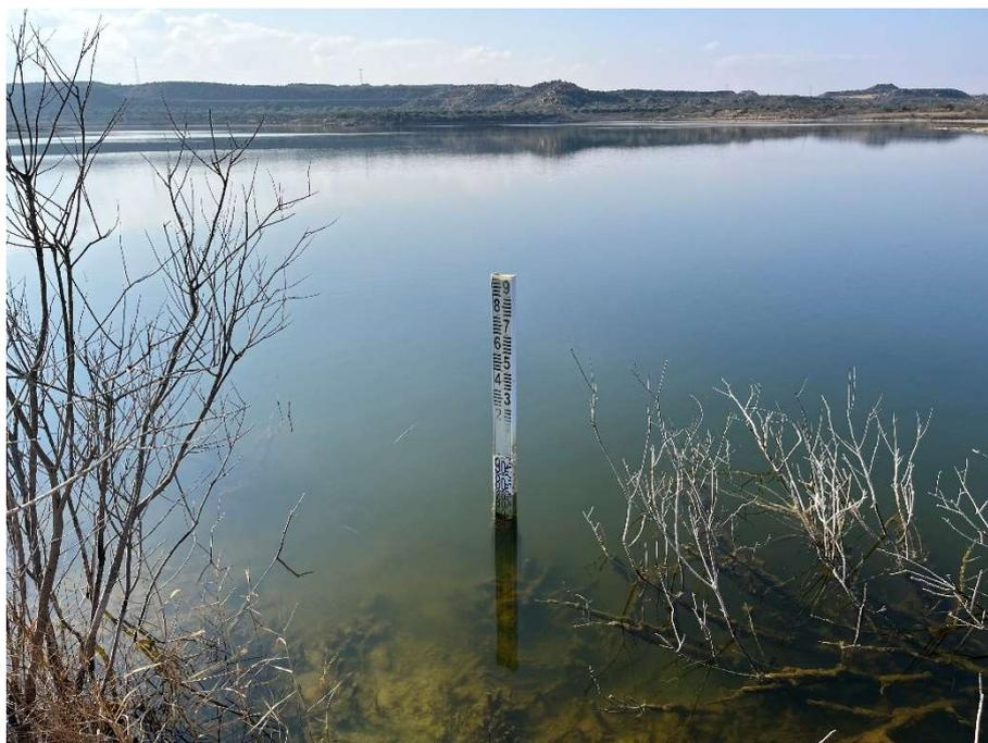
Foto 15. Regleta para el control de la altura de la lámina de agua en la salada grande.
