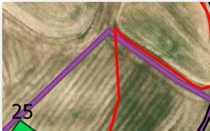
Fig. 4. Imagen en planta de servidumbre de caminos para acceso a los apoyos de la línea aérea (superficie marcada en color morado)
