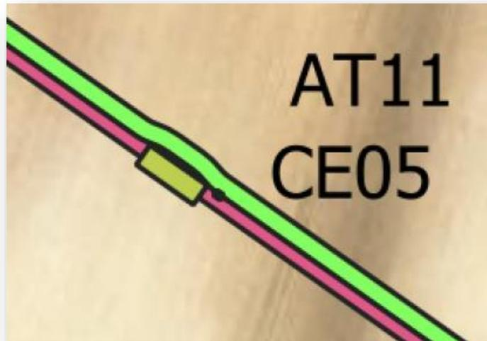
Fig. 8. Imagen de planta de superficies afectadas por Cámara de Empalme (rectángulo color verde pistacho), y a su lado derecho, una arqueta en color negro entre el color rosa de la servidumbre de la canalización y el color verde de la ocupación temporal.
