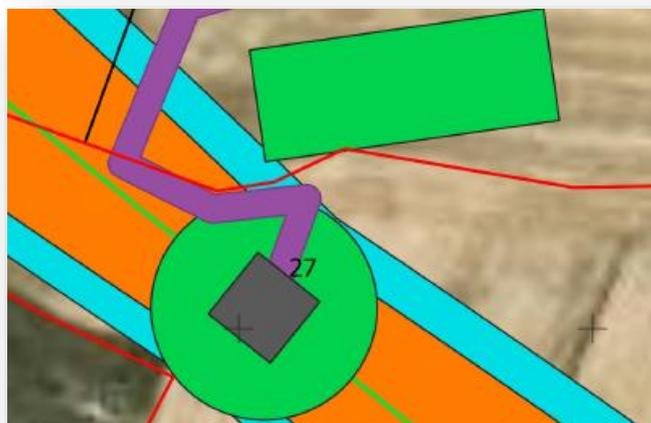
Fig. 5. Imagen de planta de ocupación temporal para montaje y construcción de la línea (superficie marcada en color verde).
