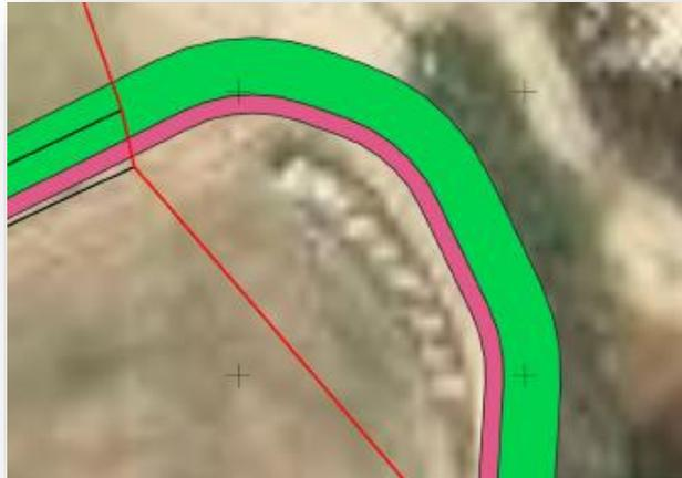
*Fig. 6. Imagen de planta de superficies afectadas por Servidumbre de Paso Subterráneo de Energía Eléctrica, marcada en color rosa (en verde la ocupación temporal).*
