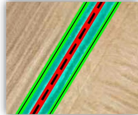
*Fig. 5. Imagen de planta de superficies afectadas por Servidumbre de Paso Subterráneo de Energía Eléctrica, marcada en color rojo.*
