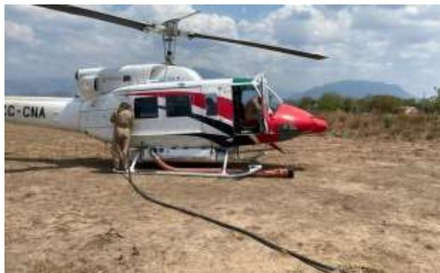
Figura 27.: Helicóptero repostando fuera de una base fija.
