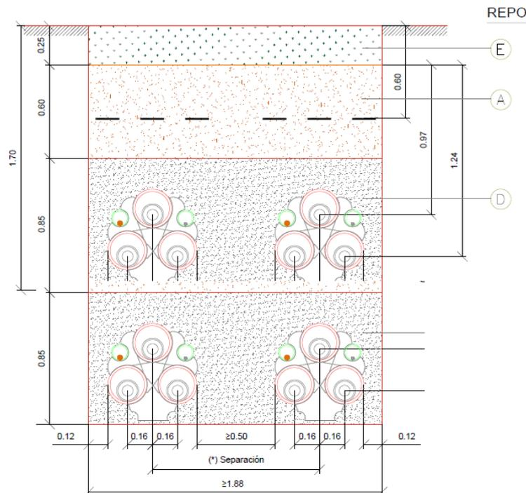
Para el tendido de los cables de potencia se instalarán por cada circuito 6 tubos de 250 mm de diámetro exterior, en disposición al tresbolillo. Los tubos serán rígidos corrugados de doble pared, fabricados en polietileno de alta densidad.
