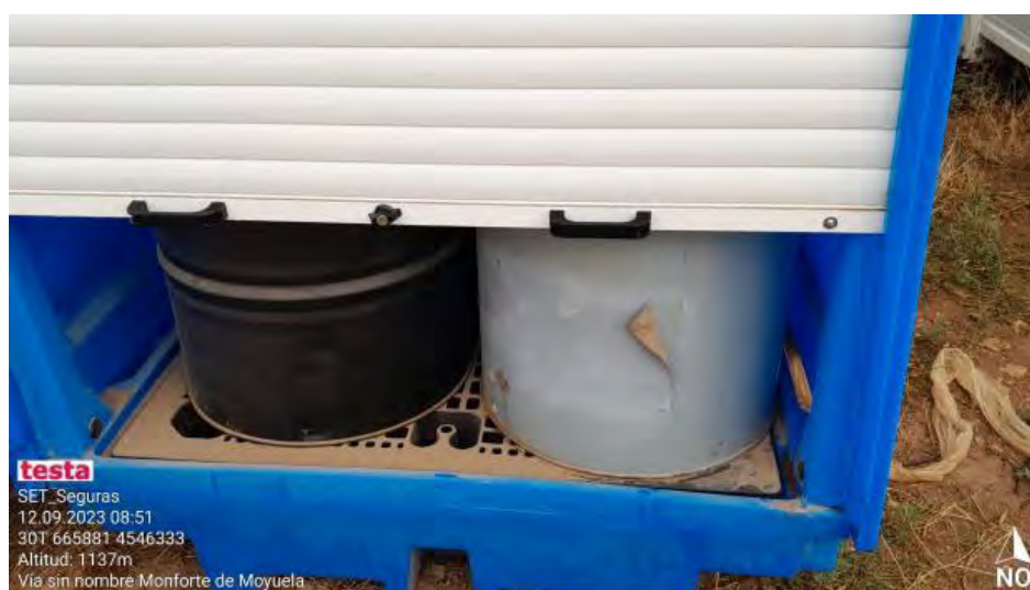
Contenedor sin cerrar
