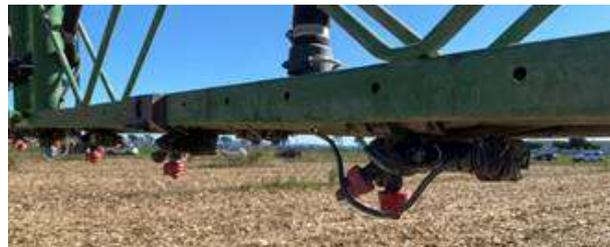
Foto 7. Equipo de aplicación de herbicidas.
