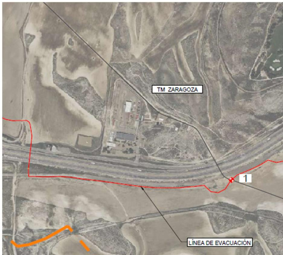
*Ilustración 5: Afección línea de evacuación con gasoducto de ENAGÁS, S.A.*
