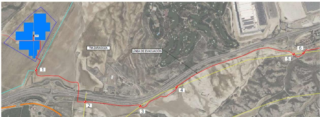
*Ilustración 5: Afecciones línea de evacuación con líneas eléctricas ENDESA, S.A.*
