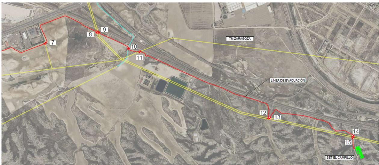
*Ilustración 6: Afecciones línea de evacuación con líneas eléctricas ENDESA, S.A.*
