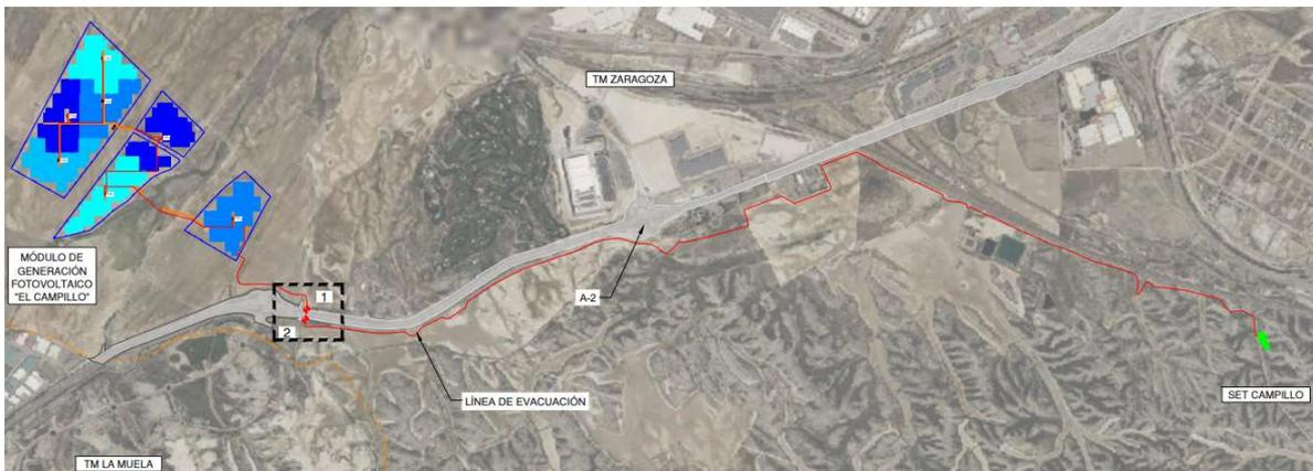
*Ilustración 5: Cruzamientos de la línea de evacuación con la autopista A-2*
