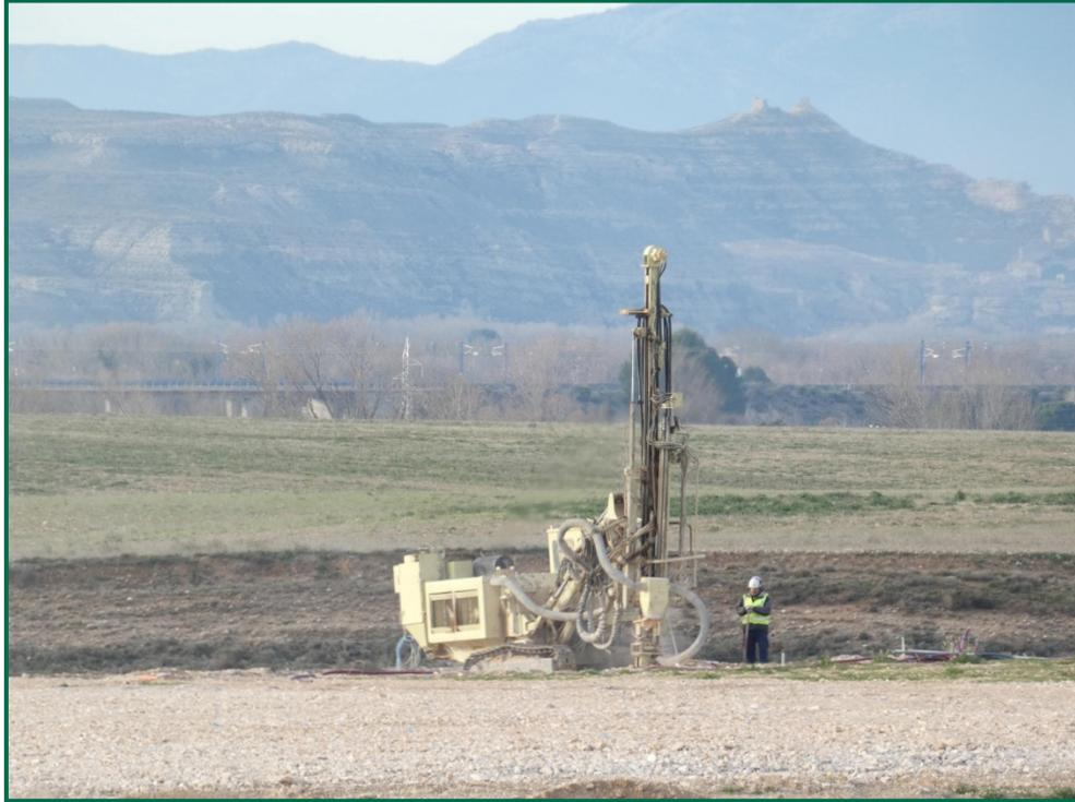
Fotografía 1. Maquinaria hincapostes realizando pruebas de incado.
