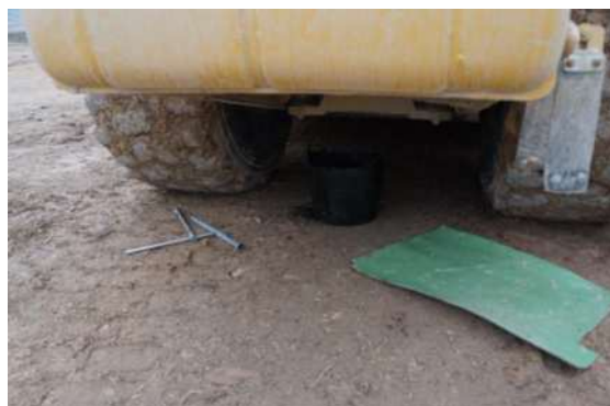
Figura 25 Cambio de aceite incorrecto
