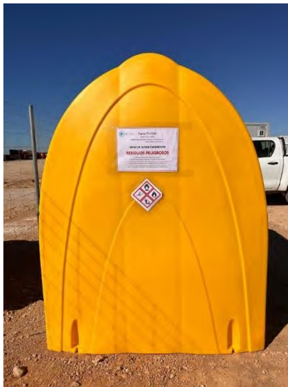
Figura nº 76. Depósitos de PE con persiana para sustancias peligrosas (lateral).
