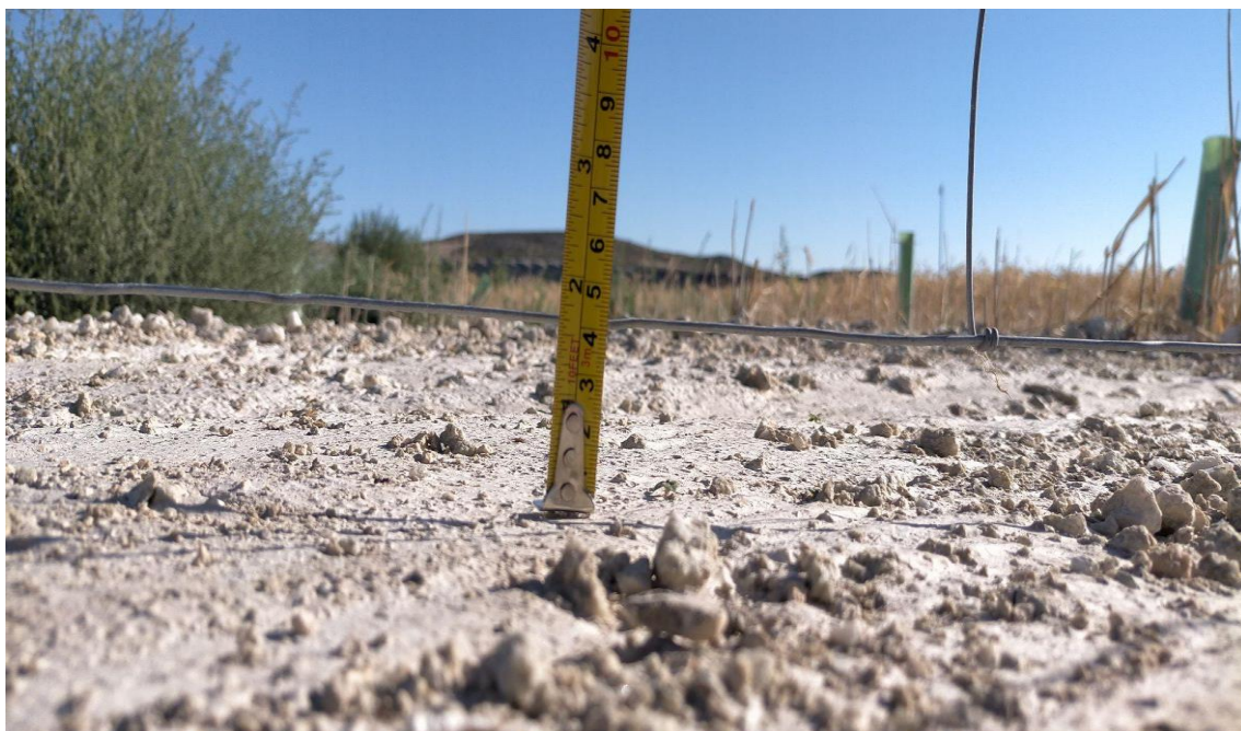
Fotografía 8. Espacio entre vallado y suelo junto a la entrada de Fede 2, en el mes de julio, tras la acumulación de sedimentos
