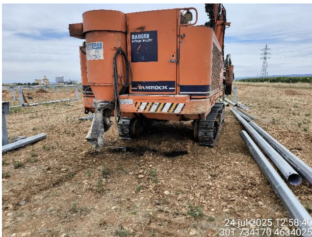
Figura 9: Hincadora en la obra con derrame de aceite, se informó al jefe de obra y esta ya no se encuentra operativa.
