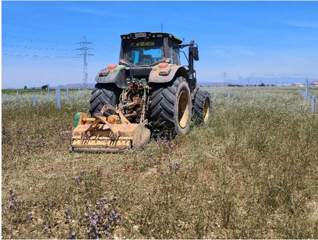
Figura 7: Desbroce del PFV con tractor.
