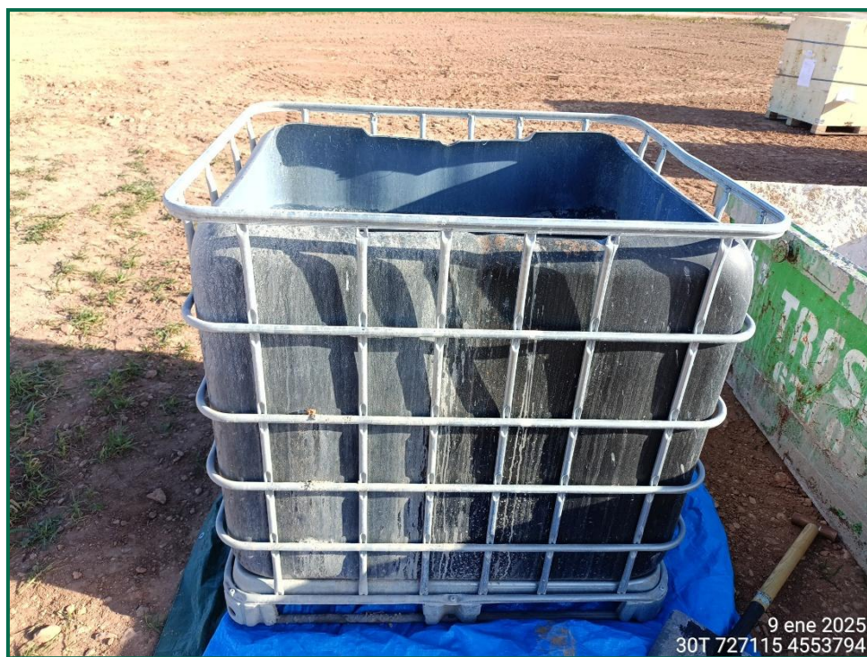
Fotografía 15. Contenedor para lavado de canaletas.
