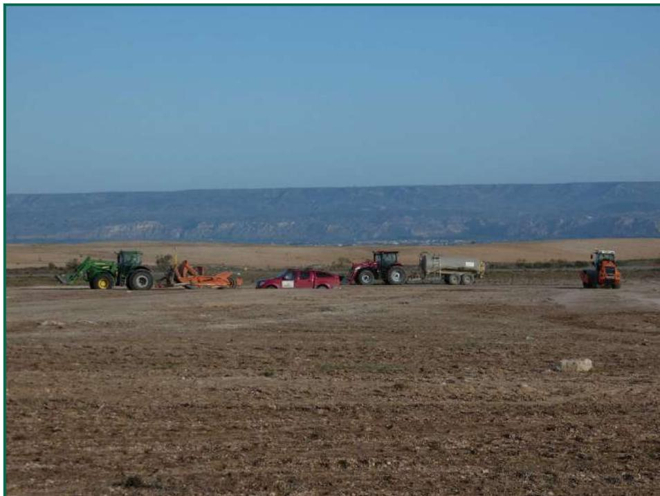
Fotografía 10. Cuba de riego y maquinaria para el allanado.
