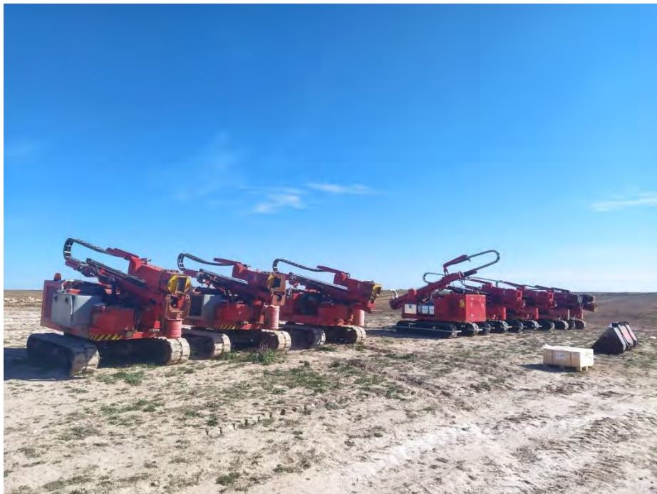
Fotografía 16. Hincadoras, todavía sin utilizar.
