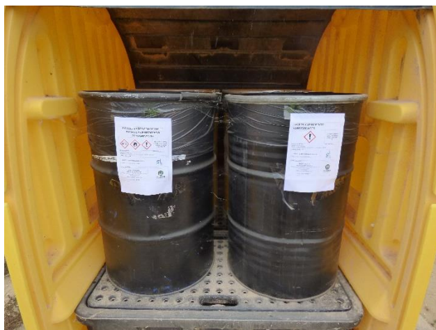
Imagen 16. Los residuos peligrosos son depositados en contenedores homologados adecuadamente identificados situados en el interior del punto limpio
