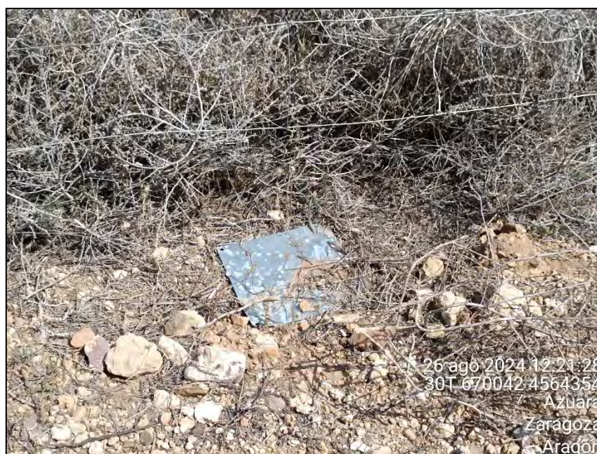
Figura 10: Placa anticolidión descolgada y tendida en el suelo.
