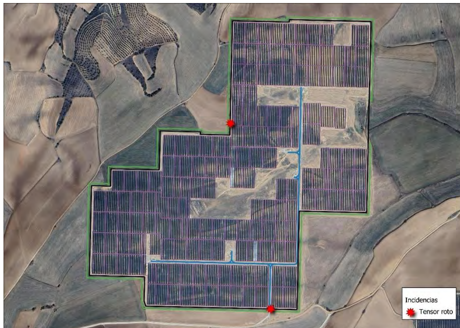
Figura 23: Ubicaciones en las que se ha detectado tensores rotos.
